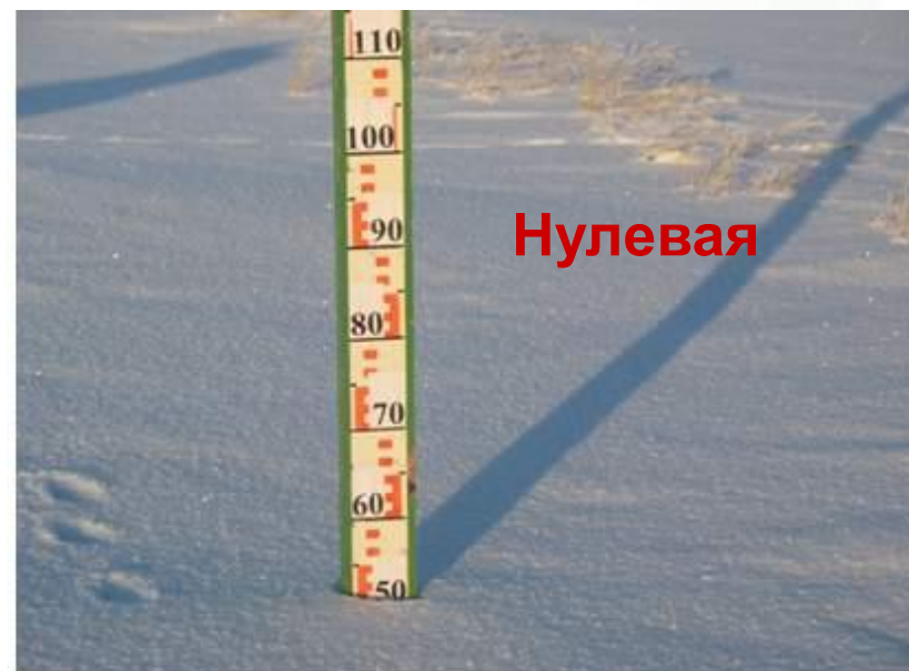
Накопление снега по стерне, h=51 см, запасы воды в снеге 117,3 мм
