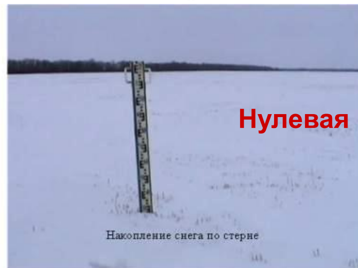
Накопление снега по стерне, h=51 см, запасы воды в снеге 117,3 мм
